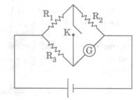
उपर्युक्त परिपथ में, प्रतिरोधकों के मान इस तरह हैं कि  $\frac{R_1}{R_2} = \frac{R_3}{R_G}$ , जहाँ  $R_G$  गैल्वनोमीटर का आंतरिक
